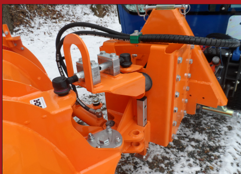
Doozerbladet er monteret på et affjederet ophæng som er opbygget på en standard A-ramme
