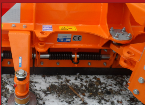
Det sektionens opdeltede klapskær sikrer at skæret klapper væk hvis det møder en forhindring i underlaget
