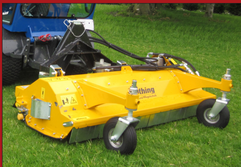
Klipperen er opbygget med flydende-ophæng og er udstyret med kraftige gummi hjul, foran klipperen
