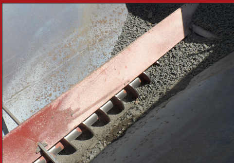
En central placeret snegl i bunden sørger for effektiv fremføring af sprednings materialet
