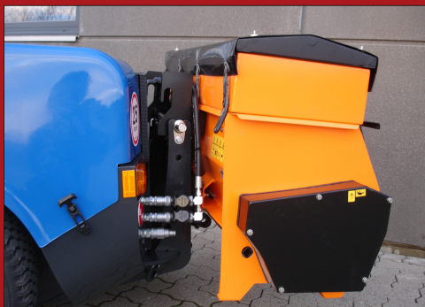
Sprederen kan som tilvalg leveres med beholderring som øger kapaciteten af beholderen
