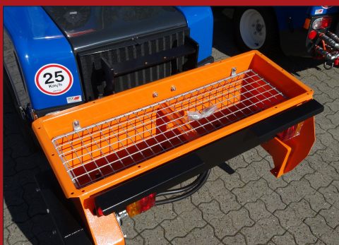
Valesprederen er udstyret med hydraulisk omrører som er afskærmet af gitterrist for optimal sikkerhed
