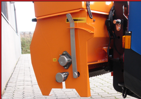
Doserings mængden justeres manuelt ved hjælp af håndtag på spreders højre side
