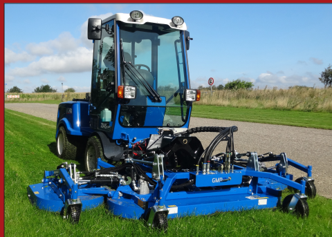
Klipperen leveres med bagudkast. Mulchingkit er muligt som tilvalg. Gummihjul sikrer optimal justering og stabilitet.
