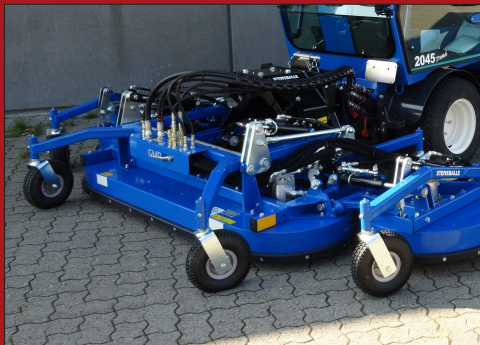
Robust opbygning med en kraftig rammekonstruktion med fleksibelt ophæng på Cat.1 A-ramme
