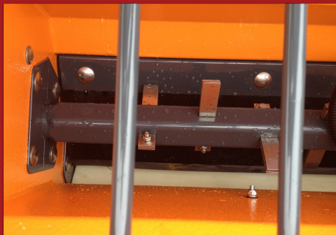
Sprederen er udstyret med rustfri omrører system, som sørger for sprednings materialet ikke klumper
