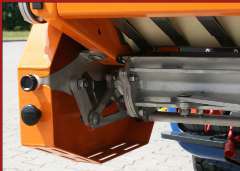
Skift mellem valg af valse- eller tallerkenspreder foregår nemt og bekvemt fra kabinen
