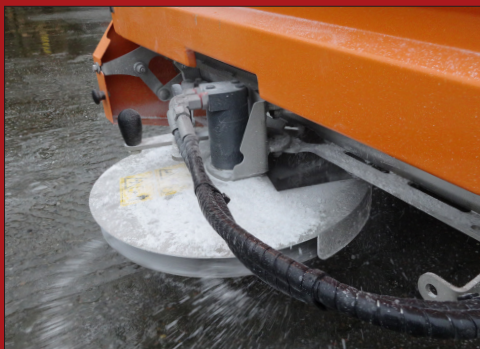
Alle dele på sprederen er enten udført i rustfri stål eller lakeret med lak i korrosionsklasse C5
